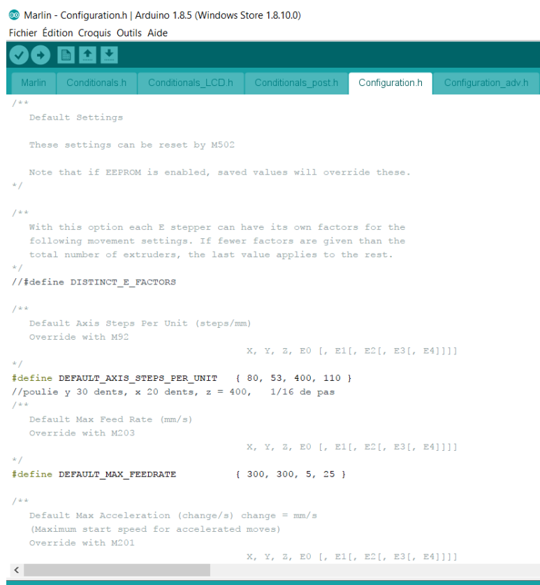
Figure 15: exemple du code Marlin dans Arduino
