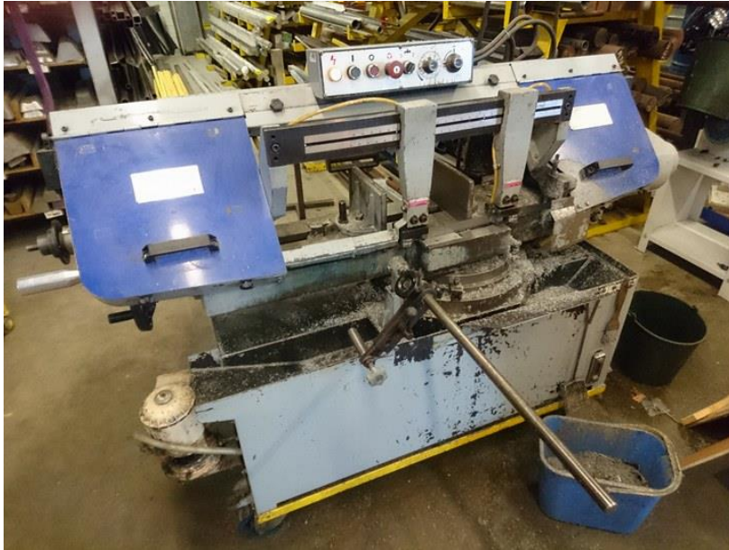
Figure 17: Scie à ruban à métaux, utilisée pour la découpe de profilés Bosch
