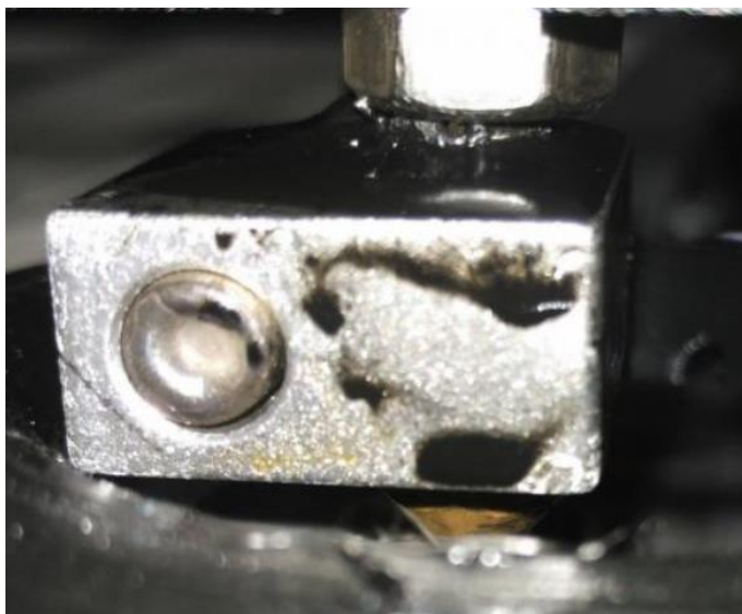
Figure 21: photo de buse recouverte de plastique fondu, car défaut d'étanchéité
